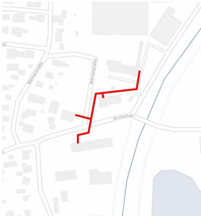
Abbildung 14: Schematische Darstellung des Wärmeverbunds zwischen Grundschule, Ärztehaus, Feuerwehr und Bauhof (nach Anlage 2 WPG Abs. I Nr. 2.8.aa)
