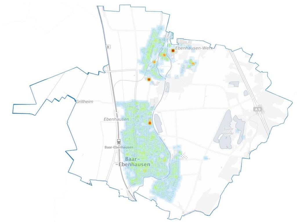
Abbildung 19: Heatmap in Abhängigkeit des Wärmebedarfs
