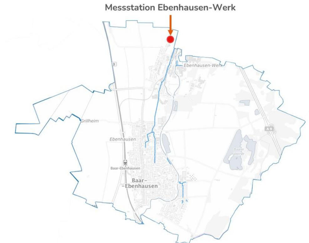
Abbildung 45: Abwassernetz gefiltert nach Abschnitten mit Höhe und Breite größer 800 mm inkl. Darstellung der Messtation Ebenhausen-Werk
